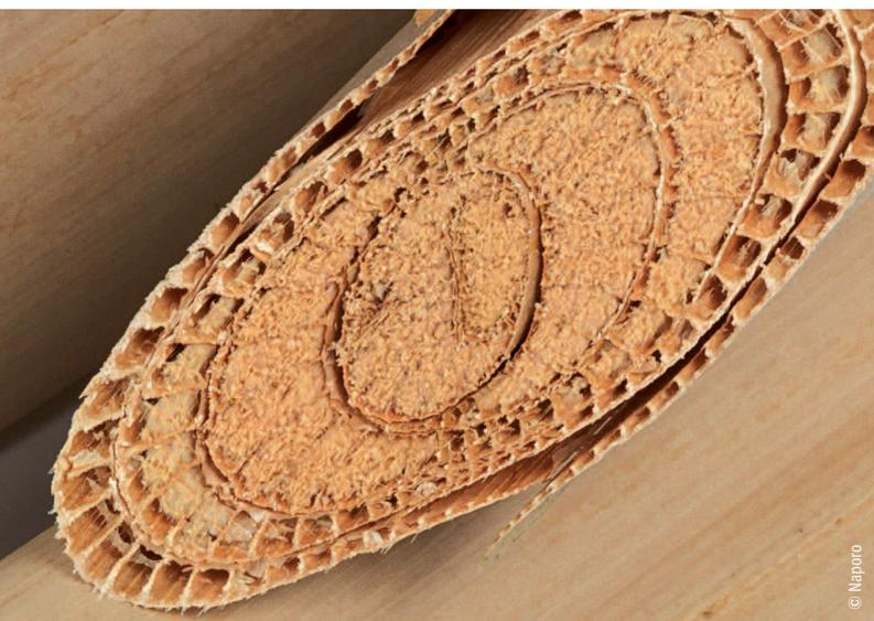
Zellwände und Zellhohlräume des Rohrkolbens
